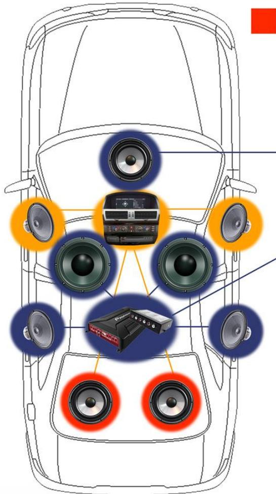
**Рисунок 4. Структурная схема подключения MOST-RCA 3.0 при замене штатного усилителя с сохранением штатной акустики**
