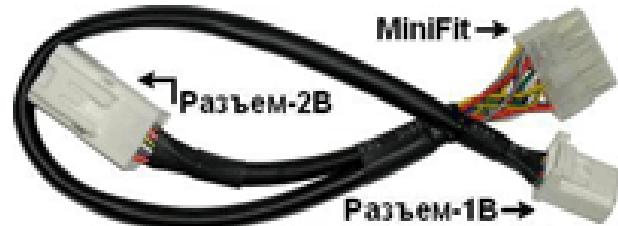
Рис.2.1. Переходник MiniFit-Toyota \_6+6
