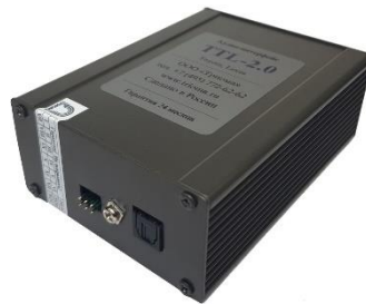
Рис.2. Адаптер TTL-3.0 (сторона с разъемом TosLink)
