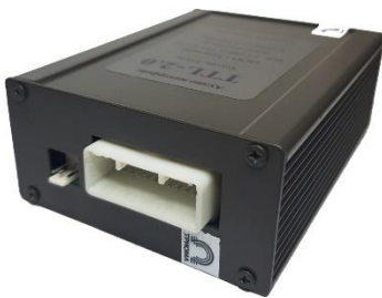
Рис.1. Адаптер TTL-3.0 (сторона с разъемом 24pin)
