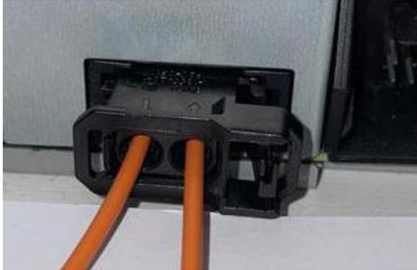
а) Извлечь коннектор #1 с двумя нитками, например, из головного устройства
