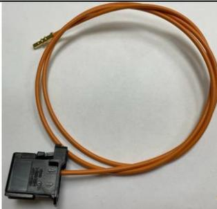
в) в «OUT» установить дополнительную нитку и подключить коннектор #1 обратно, например, в головное устройство
