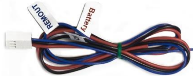
Рис.3. Кабель питания (Batt, GND, Rem)
