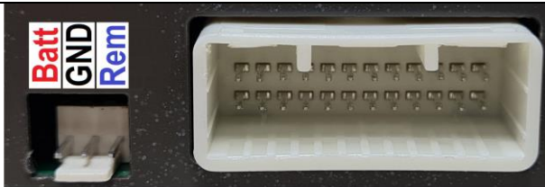
Рис.2. Разъем питания и разъем 24pin
